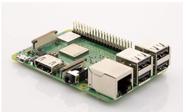
Tali sensori erano costituiti da dei *Raspberry Pi 3* (ovvero da una singola scheda elettronica implementante un intero computer) dotati del sistema operativo nativo di Raspberry, basato su Unix, ai quali è stata aggiunta una scheda WiFi 802.11 esterna per poter rilevare la trasmissione di dati wireless tramite tale protocollo di comunicazione.
